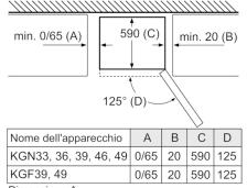
Dimensione A: nei modelli con maniglie integrate verticalmente, per aprire agevolmente è necessaria una distanza minima di 65 mm.
