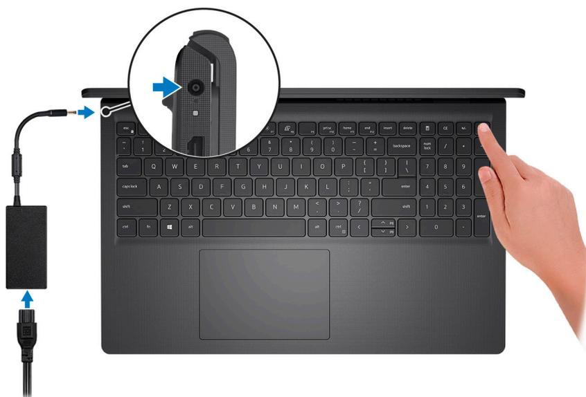
**i** **N.B.:** Per conservare autonomia, la batteria potrebbe entrare in modalità di risparmio di energia. Collegare l'adattatore per l'alimentazione e premere il pulsante di accensione per accendere il computer.
