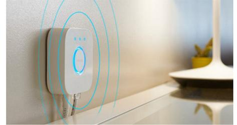
Il Bridge Hue è un componente essenziale di un sistema di illuminazione connessa personale Philips Hue. Funziona da cervello operativo, comunicando sia con le lampadine connesse che con l'app Hue per assicurarti che tutto funzioni correttamente. Inoltre, il bridge attiva funzioni di automazione della casa connessa come la pianificazione delle routine e dei timer.
